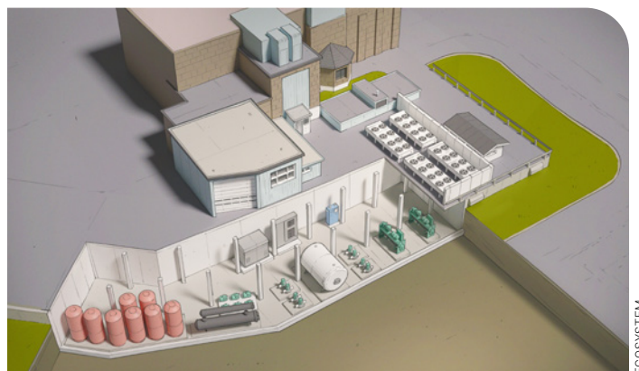
L'ancienne soute où était entreposé le charbon à l'époque n'était plus utilisée depuis des années. Ecosystem y a vu l'opportunité d'y implanter une nouvelle centrale thermique où sera notamment installée la nouvelle thermopompe au CO 2 .
