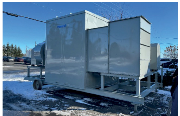
Figure 2c : Exemple intégral de roue thermique incluant le boîtier de l'équipement.
