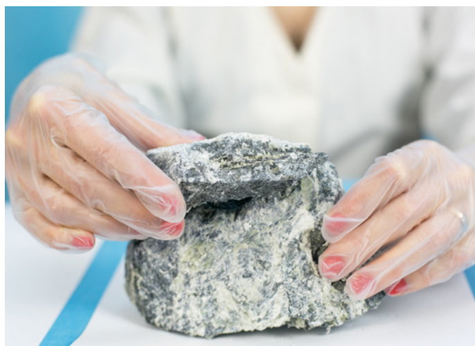
L'amiante est une roche naturelle fibreuse qui, par ses propriétés physiques et chimiques, a énormément servi sur les chantiers de construction.
