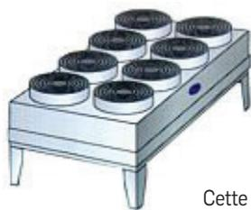
L'aérorefroidisseur est un simple échangeur eau/air : un ou plusieurs ventilateurs forcent le passage de l'air extérieur pour accélérer le refroidissement.
