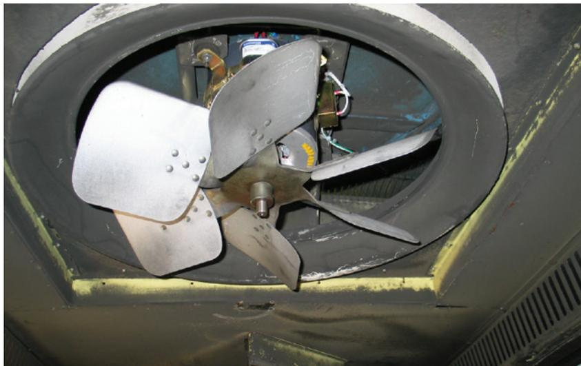
Ci-dessus, au centre de la photo, on retrouve le ventilateur d'entrée d'air et sur les côtés, les grilles de diffusion d'air typique d'une voiture MR-73
