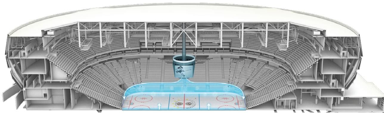
Fig. Principe de ventilation par le tableau d'affichage
