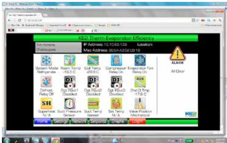
Figure 7 - Fenêtre du contrôleur
