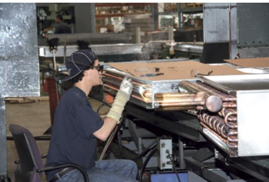
Fabrication minutieuse d'un serpentin.
