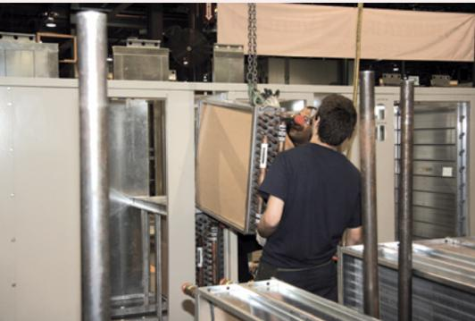
Insertion d'un serpentin dans une unité de traitement d'air.
