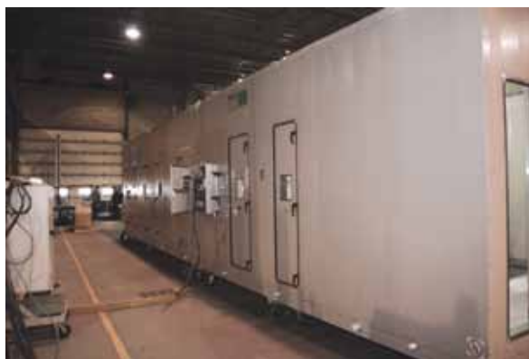
Avant d'être livrées en sections, les centrales d'air sont assemblées et testées.
