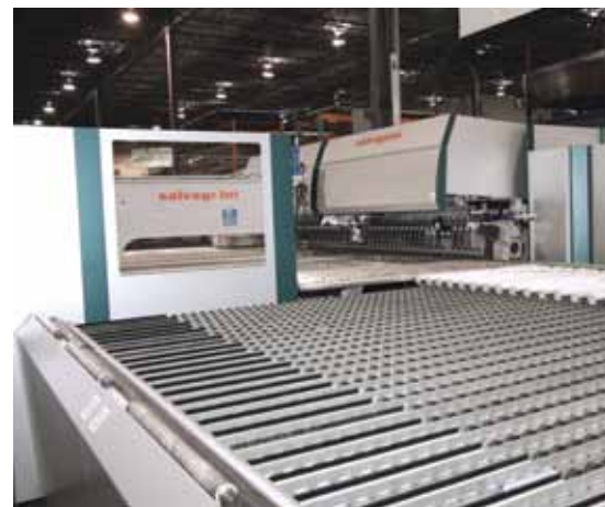
Cette machine-outil automatisée plie et poinçonne les panneaux de métal en feuille.
