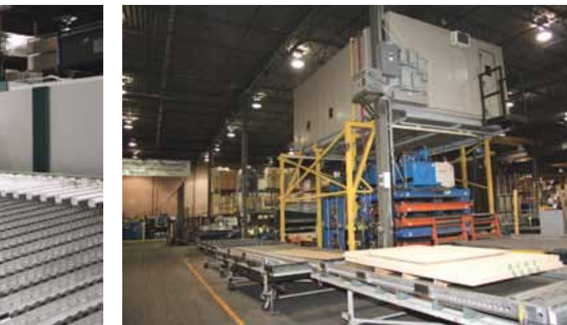
Cette gigantesque presse injecte la mousse isolante dans les panneaux.
