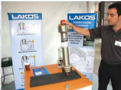
Le mouvement centrifuge du filtre sépare les solides du liquide.
