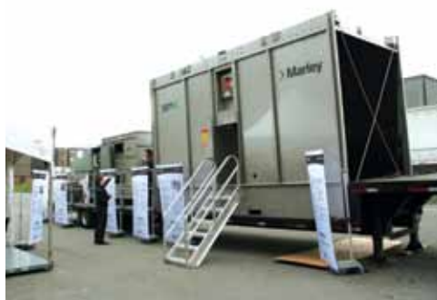
La tour de refroidissement sur une remorque de 52 pieds.
