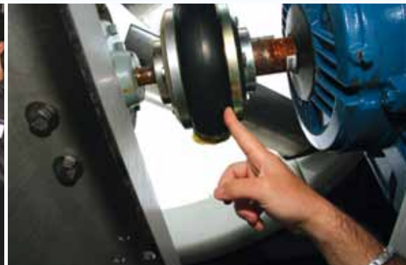
L'entraînement par engrenage scellé avec de l'huile synthétique.
