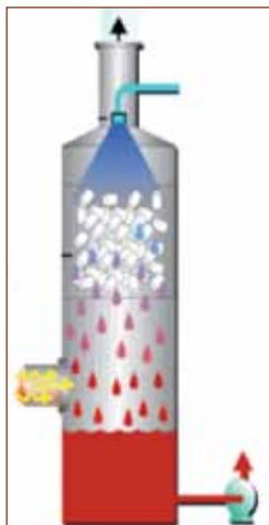
**Schéma d'un économiseur à contact direct**
