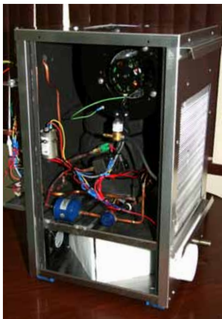
L'unité centrale à air soufflé MiniClim intègre un échangeur d'air récupérateur d'énergie, un humidificateur, un compresseur et un filtre.
