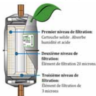
Figure 6 : Trois niveaux de filtration
