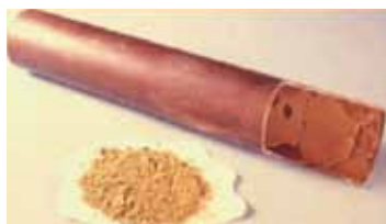
Figure 1 : Dégradation de l'huile minérale
