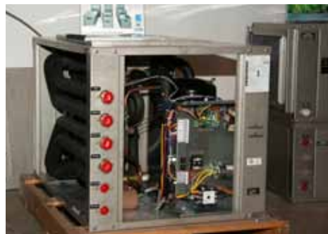
Une unité géothermique Hydron Module eau-eau pour le chauffage de l'eau domestique ou de l'eau de chauffage, ou encore pour l'alimentation d'un plancher radiant.
