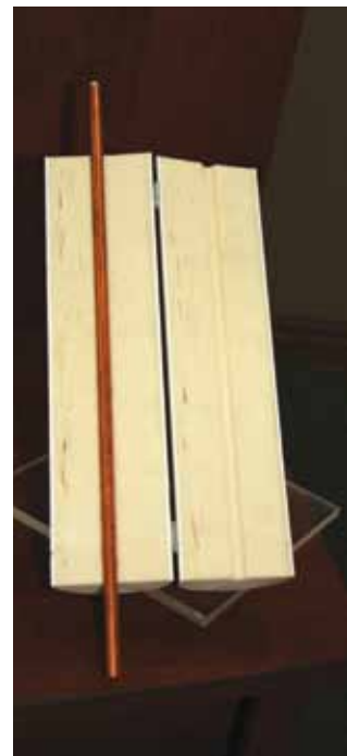
La tuyauterie de CO 2 insérée dans un tuyau de plastique rempli d'une mousse isolante.
