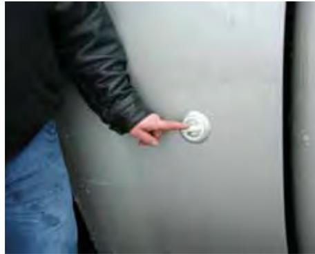
**Seul élément visible de la conversion au propane : la soupape de remplissage sur le côté.**
