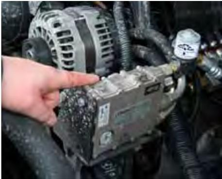
**Une des composantes de la conversion au propane : le module de commande des injecteurs.**
